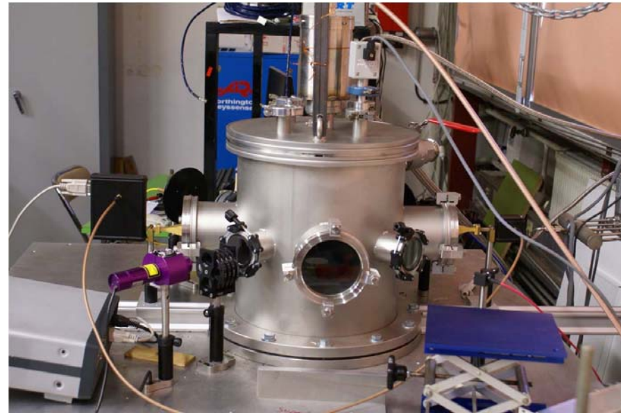
Emetteur (à gauche) et récepteur (à droite) installés sur le réacteur diode RF
