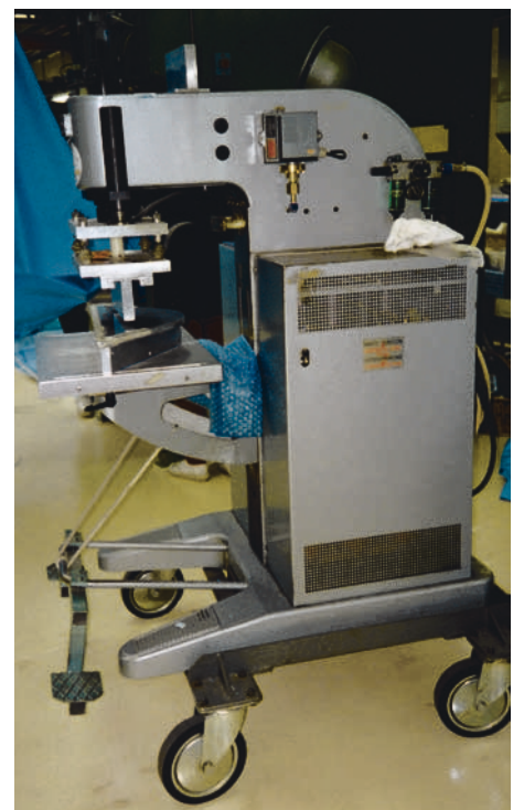
Photo 8. Presse de soudage HF du plastique.
